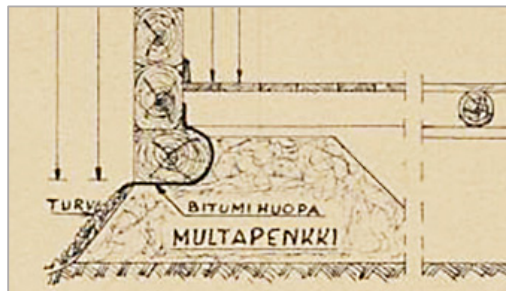
Kuva esittää multapenkkiperustusta, jossa on modernina lisäyksenä bitumihuopa. Aiemmin sen sijasta käytettiin koivun tuohilevyjä. Lähde: Piirustus nro 1400/ Asutushallituksen rakennustoimisto 29.12.1934. Kansallisarkisto.
