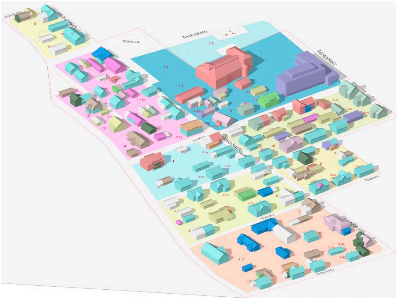
Kuva 11 Tehokkuusluvun 0,3 laajennusrakentaminen alueella
