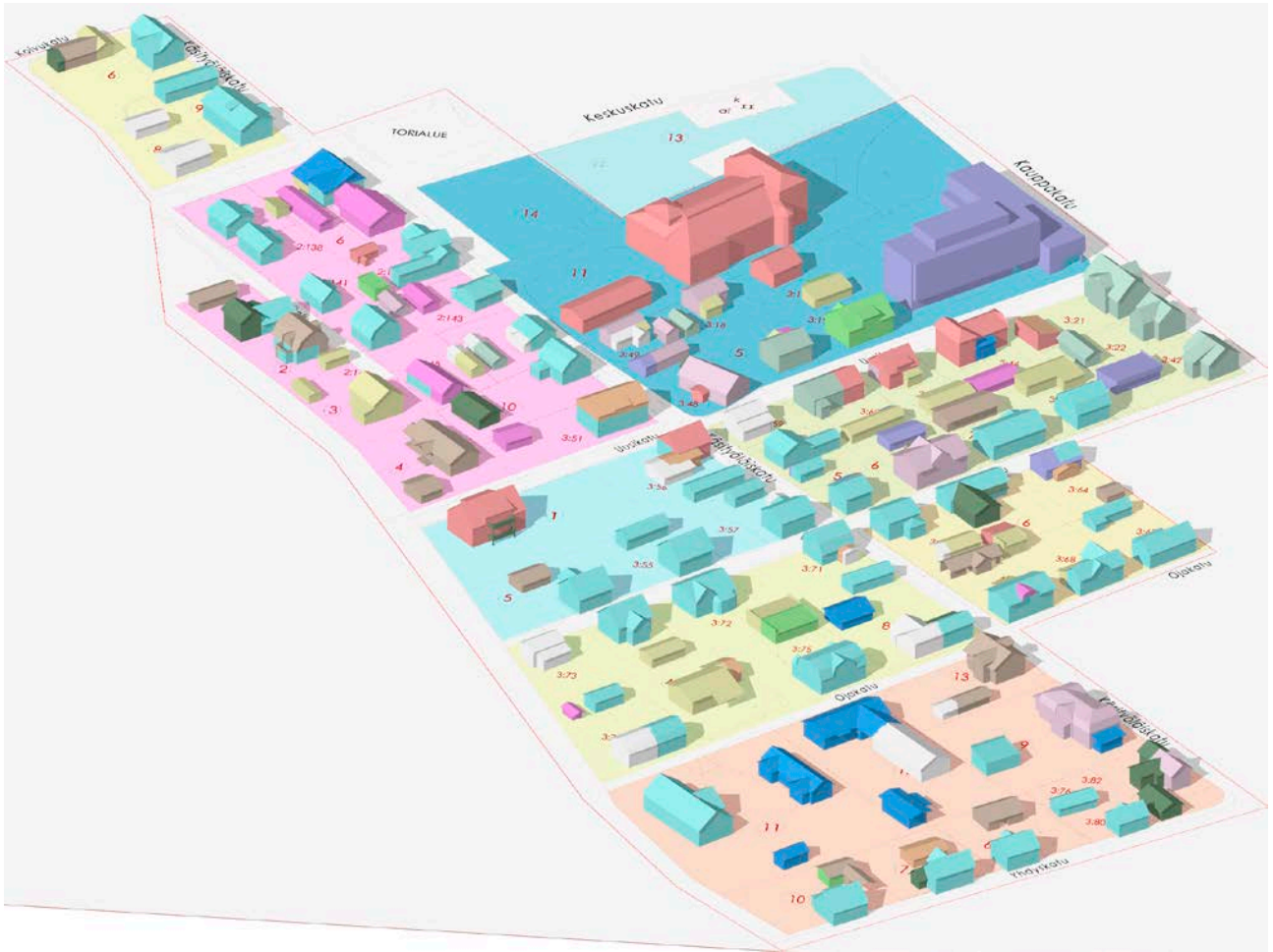
Kuva 14 Tehokkuusluvun 0,25 laajennusrakentaminen alueella
